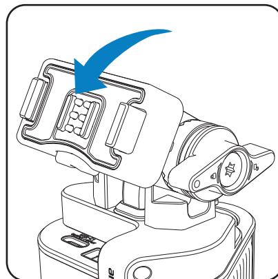
3. 锁定角度：调节完毕后，将旋钮顺时针旋转约 90°，完成锁定。
