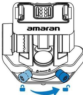
2. Alinee el pasador de posicionamiento del módulo de Expansión de amaran Ace E-Lock con el orificio de posicionamiento en la parte superior del amaran Peak.
